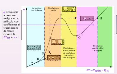
CRISI D'EBOLLIZIONE PER CALEFAZIONE Quando non si fissa  $\Delta T_{\rm Sat}$  ma il flusso termico q, si "salta" direttamente da F a H: il vapore forma brutalmente una pellicola che isola termicamente
