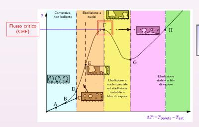
Innalzando ancora T si formano chiazze di vapore intorno alla parete che tendono a formare una pellicola isolante di vapore: q diminuisce anziché aumentare (il vapore è un pessimo conduttore di calore)
